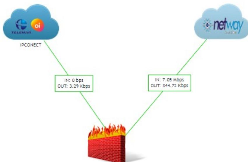
Quando uma operadora apresenta falha na comunicação, outro link entra em ação de forma automática sem que os usuários percebam.
