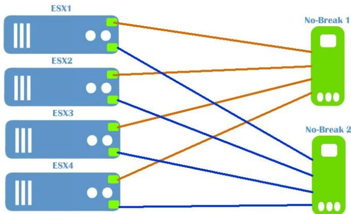
Utilizamos 02 (dois) no-breaks onde interligamos fonte de energia de cada servidor em nobreaks diferentes, conforme ilustrado no desenho acima.
