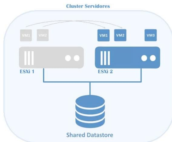
O PREVINI utiliza para gerenciamento dos Hosts de seu datacenter uma ferramenta chamada VMware ESXi na versão 6.7, através dessa ferramenta podemos gerenciar o Cluster de Servidores que é composto por 2 Servidores físicos com o Sistema Operacional ESXi.
