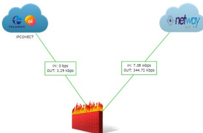
Quando uma operadora apresenta falha na comunicação, outro link entra em ação de forma automática sem que os usuários percebam.
